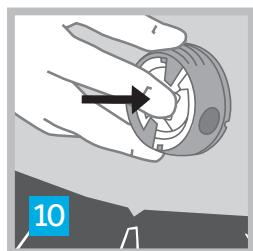
Надавите на центральную часть устройства для введения для надежного крепления ай-порт адванс на коже
