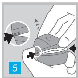
Снимите пластиковую крышку с устройства
